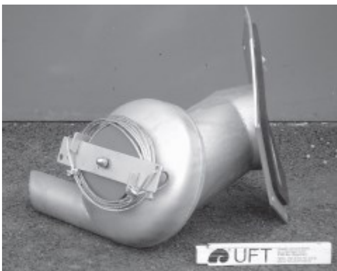
Obr.5: vírový ventil z nerez oceli typ SUn 45-4 DN150, natočení o 45°, levotočivý, se zaoblenou kotevní deskou pro kruhovou šachtu
